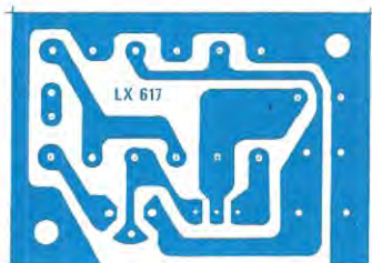
Fig. 2 Disegno a grandezza naturale del circuito stampato
