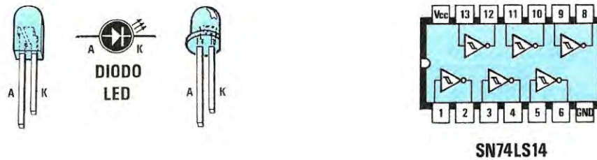
Fig. 2 Le connessioni viste da sopra dell'integrato 74LS14 e dei terminali dei diodi led. Si noti come il terminale Anodo sia piu' lungo del Catodo. Qui sotto, ecco come si presenta la scatola in plastica sulla quale anteriormente è già fissato il connettore femmina da innestare nel computer.
